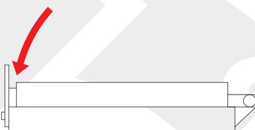
По завершении цикла кнопка загорается. Откройте крышку или решетку, прижимные пластины поднимаются, высвобождая тестовые заготовки.
