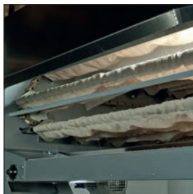
Лотки с 2 рабочими сторонами (Arconet®) Антибактериальная и гидрофобная обработка.
