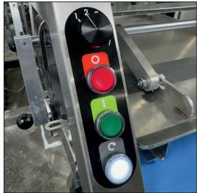
Einfache und ergonomische Steuerung mit Auswahl der Teigstückanzahl pro Behälter
