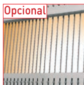
Opcional Doble rebanada Permite dos anchuras de corte diferentes en la misma máquina.
