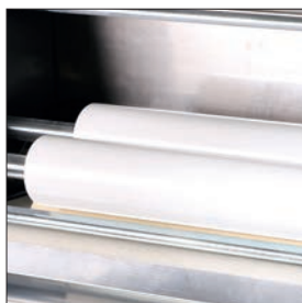
Tres rodillos de laminación en polietileno alimentario
