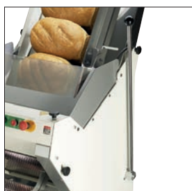
Leva laterale Permette di realizzare il taglio della parte finale del pane in totale sicurezza.
