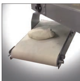
Torretta di scarico Orientabile a 180° per una configurazione con formatrice esterna.
