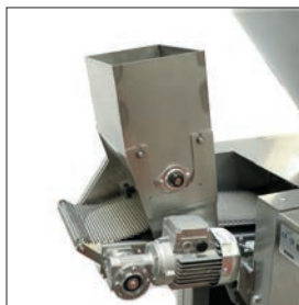
Farineur autonome Permet d'éviter que les pâtons collent sur le tapis.
