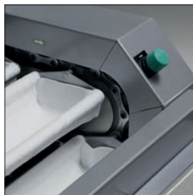
Pignon avec bague en bronze Réduit le frottement et augmente la durée de vie.
