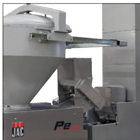
Farineur d'auges Permet d'éviter que les pâtons collent.
