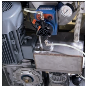
Système de recyclage d'huile Permet de limiter fortement la consommation d'huile. Equipé d'un filtre à cartouche et d'une alerte niveau bas. Remplissage par l'extérieur.
