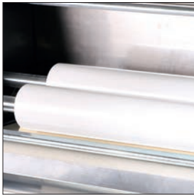
Zwei Ausrollwalzen aus lebensmittelechtem Polyethylen
