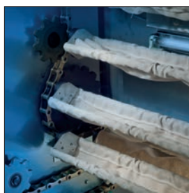
Kiemdodende UV-lamp met bescherming en luchtafzuiging Steriliseert de rijzone en voert het vocht af
