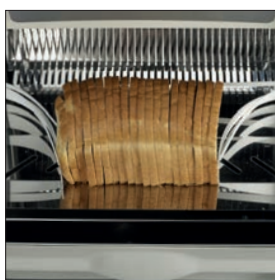
JAC FLAPS Zorgt ervoor dat het brood bij elkaar blijft na het snijden om het makkelijker uit de machine te nemen.
